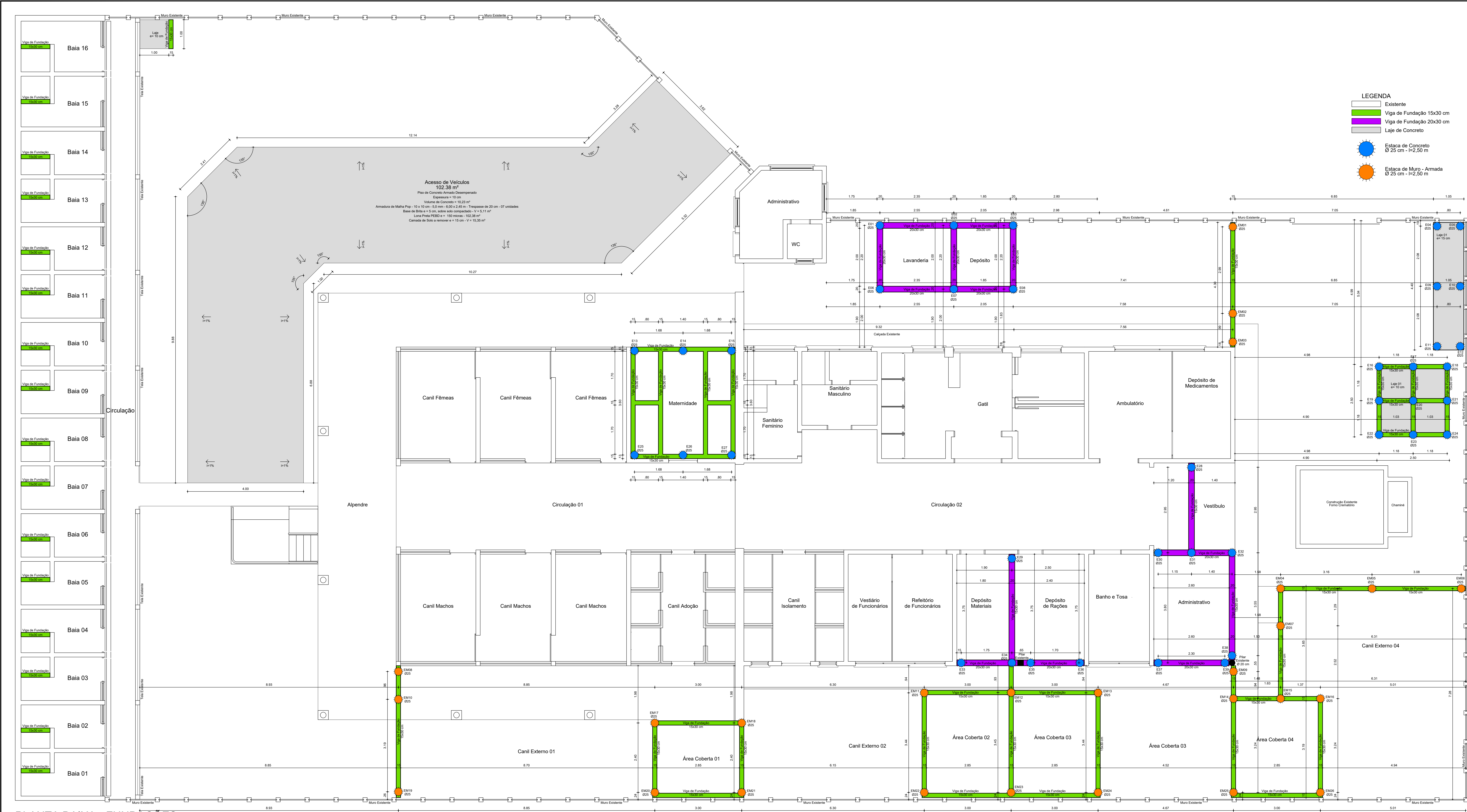
PLANTA BAIXA - FUNDAÇÕES ESTACAS E VIGAS DE FUNDAÇÃO ESCALA 1/50
